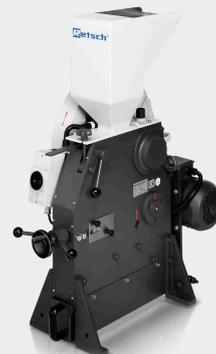
Щековая дробилка ВВ 100 используется для **быстрого бережного предварительного измельчения средне-твердых, твердых, хрупких и прочных материалов.**
