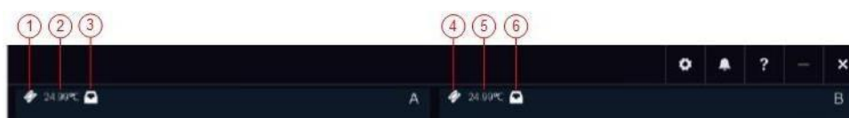
Рисунок 15. Описание значков состояния для проточной ячейки, температуры платформы проточной ячейки и картриджа
