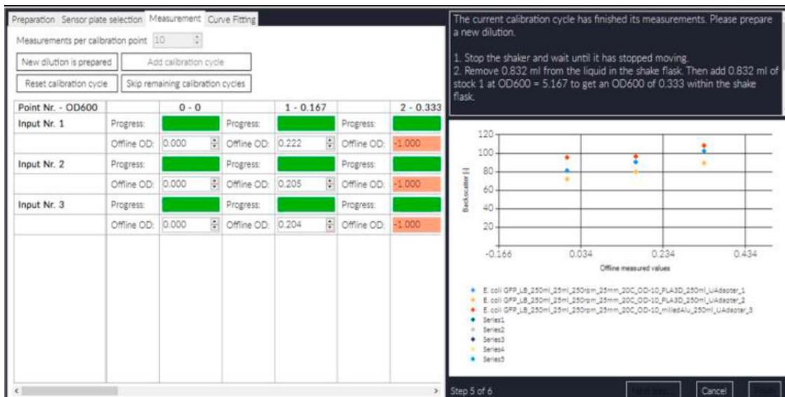
Рис. 28. Обзор процесса измерения калибратором CGQuant.
