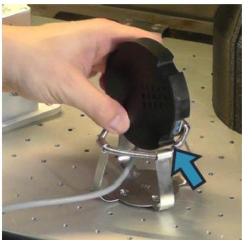
Затем поверните пластину датчиков против часовой стрелки к концу кабеля, пока фиксирующая вырезка между USB-портом и кабелем не окажется над правой лапкой металлического пружинного зажима.
