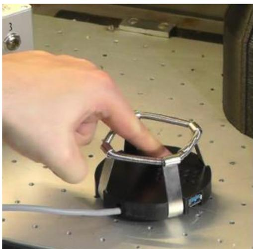
Наконец, пластина датчиков должна встать на место в пружинном зажиме со щелчком, и ее положение должно быть подходящим для использования устройства CGQ.
