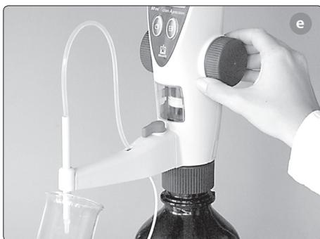
**е)** Дозируйте жидкость до тех пор, пока в титровальной трубке не останется ни одного пузыря.
