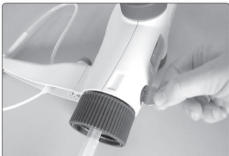
а) Откройте крышку вентиляционного отверстия с помощью монеты
