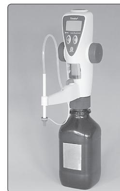
Титратор предназначен для работы с бутылками с диаметром горла 45 мм. Для бутылей с другим диаметром горла используйте соответствующие адаптеры. Титровальная трубка перемещается горизонтально и вертикально до 70 мм.
