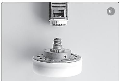
**в)** Чтобы заменить головку поршня, сперва поднимите светло-серое защитное кольцо стержня поршня вверх и затем выкрутите головку поршня.
