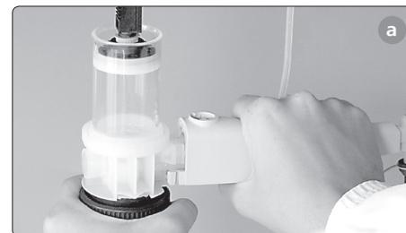
**а)** Установка титровальной трубки
