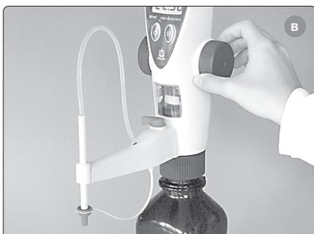
**б)** С помощью колес ручного управления полностью опустите поршень, затем поднимите его, заполните до половины и снова опустите. Повторите эту процедуру до 5 раз, пока не исчезнут крупные пузыри под поршнем.
