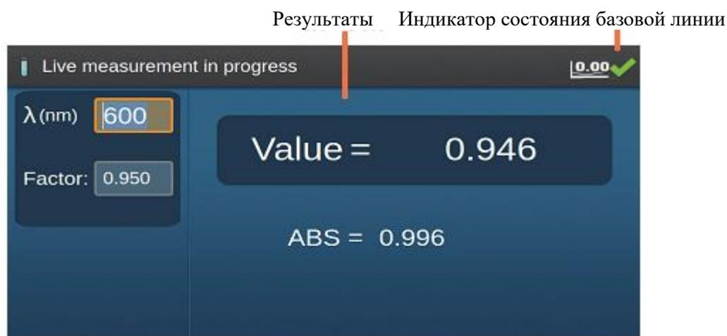
**Примечание ОП600** — режим с отображением данных в реальном времени. Показание будет обновляться автоматически раз в 2 секунды. Вставьте дополнительные пробы как необходимо, закройте крышку и подождите, пока отображаемый результат не начнет мигать, указывая, что значение обновилось.
