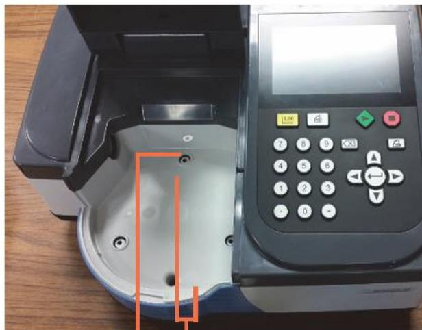
Отверстие для фиксирующего штифта      Магниты
