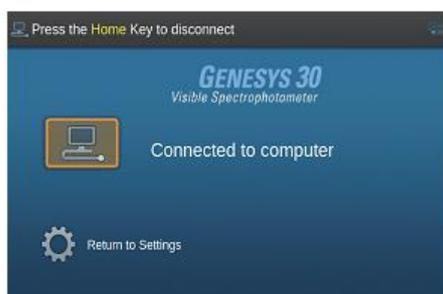
Подключитесь к компьютеру с Windows PC при помощи программы VISION lite для дистанционного управления инструментом
