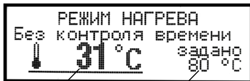
Рисунок 9 – Вид дисплея в состоянии нагрева без контроля времени
